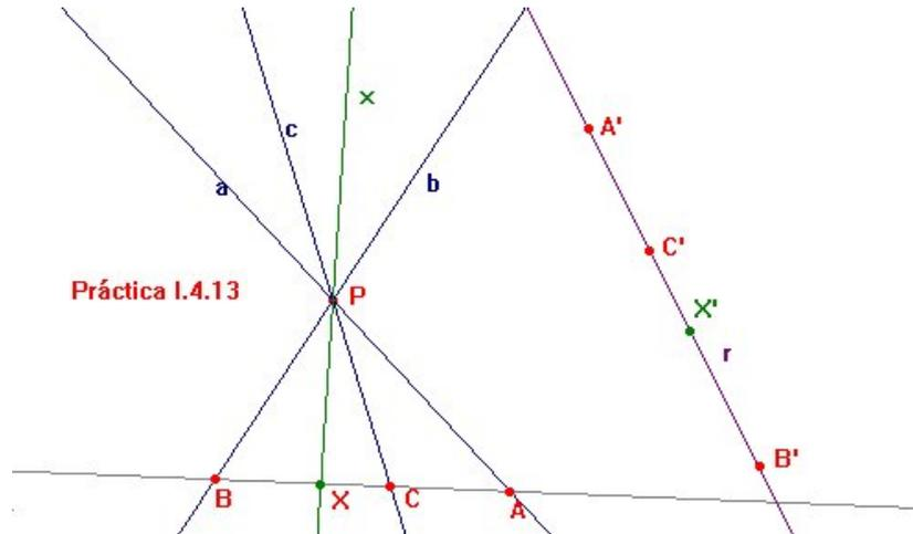
**Enunciado** De una correlación  $\sigma : P^* \rightarrow r$  entre el haz  $P^*$  y la recta  $r$  se sabe que  $a$  se transforma en  $A'$ ,  $b$  en  $B'$  y  $c$  en  $C'$ . Hállese la imagen de otra recta  $x$  del haz.
